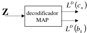
Figura 6. Bloco decodificador MAP
