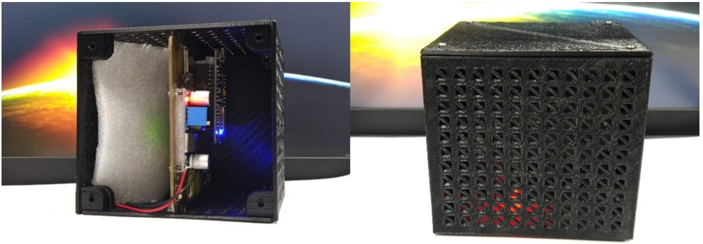
Fig. 2. CubeSat implementado para a OBSAT, evidenciando a PCI instalada internamente com o subsistema de telemetria e telecomando proposto.
